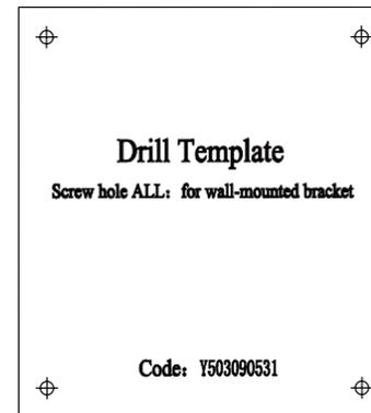
Schritt 2: Die Bohrschablone an der Wand anbringen und die Löcher entsprechend bohren. Empfehlung für die Bohrlöcher: Ø 10 mm, Tiefe > 60 mm.
