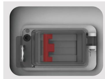
Schritt 5: Die Selbstrücksetztaste drücken, um die Batterie einzuschalten.
