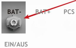
Schritt 2: Das Kathodenkabel anschließen.
